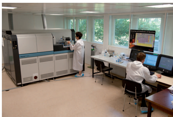
Mise en place de méthodes isotopiques Ici, analyse des isotopes du lithium, sur l'équipement NEPTUNE, afin de cerner de nouveaux indicateurs de la qualité des eaux souterraines (mesure de la composition isotopique du lithium des eaux et des sédiments du bassin de l'Allier – Massif Central – dans le cadre du projet TRANSPOSA) (photo Depoorter)
